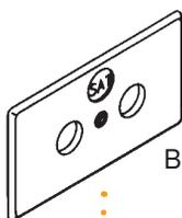
Blende für Antennenbau (mit Sollbruchstelle für SAT)
