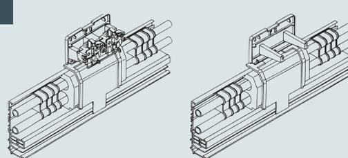
Potenzialtrennplatte ins Kanalunterteil einrasten. Die Isolierung muss links und rechts gleichmäßig überstehen.
