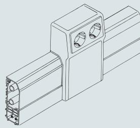
Gerätetank mit Oberteil am Boden einhängen und mit Blende verschließen.
