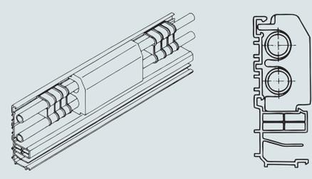
Gerätetankisolierung im Kanalunterteil einlegen (bei Vorlauftemperatur über 70 °C muss die Hartschaumvariante Art.-Nr. 6132175 verwendet werden!).
