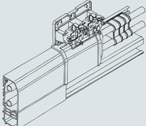
Leitungen getrennt in die Klammern legen und Steckdose bzw. sonstige Anschlussgeräte anschließen. Beide Kanalkammern (Elektro- und Heizungskammer) mit der gemeinsamen Abdeckung verschließen. Die Kanaloberteile stoßen rechts und links in die Nuten der Potenzialtrennplatte.
