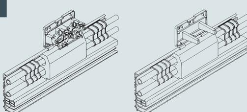
Gerätetank (mittig zur Isolierung) setzen. Anschließend die Bohrlöcher anzeichnen, bohren und den Geräteträger festschrauben.
