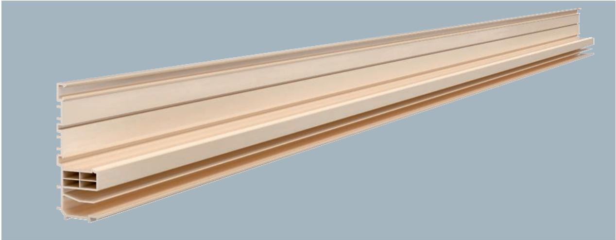
Unterteil des RAUDUO-Kanalsystems mit 2 thermisch getrennten Einzelkammern für die gemeinsame Verlegung von Elektro- und Heizungsleitungen. Mit Rastfunktion zur Aufnahme der Kanaloberteile. Die Farbe der Kanalunterteile kann fertigungsbedingt variieren.
